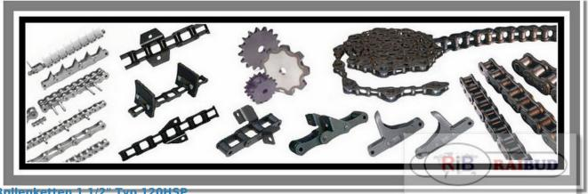
HSP-Rollenketten haben eine Bruchfestigkeit, die 20-45% höher ist als die von Standardketten. Das Wichtigste ist jedoch die höchste Schlaglastbeständigkeit unter anderen Versionen, die am zerstörerischsten für die Kette und die Kettenräder ist. Speziell ausgewähltes Material und Form der Platte, präzise mechanische Bearbeitung, spezielle Wärmebehandlung und von vier Seiten gepresste Bolzen erhöhen die Festigkeit und Abriebfestigkeit erheblich.
