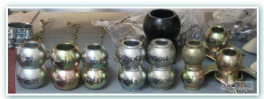
Kugel des unteren Gelenks Kat.2/2 099037
