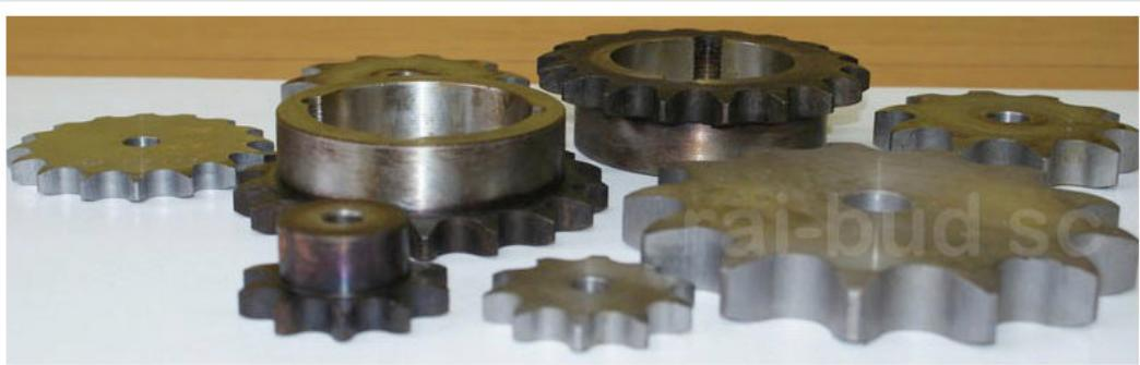
**Förderrad, das dem Originalteil mit der Katalognummer: 84820256 entspricht. Das Rad passt zur Kette in CNH-Mähdreschern.**
