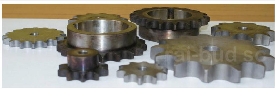
**Förderkettenrad, das dem Originalteil mit der Katalognummer: 87664054 entspricht. Das Kettenrad passt zur Kette in CNH Mähdreschern.**
